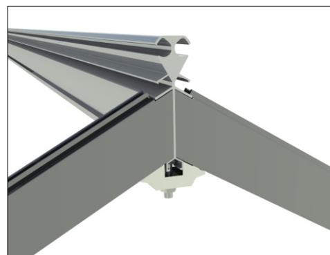
**Шаг 11** Установить крышный конек в шпроты крыши **АТП101** и **АТП102** и соединить вместе при помощи «сухаря» **ТК001**, «специального винта» **ТК200** и гаек **ТК202**.
