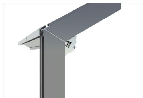
**Шаг 10** Собрать крышные коньки **АТП203** при помощи соединительной планки **ТК002** и соединительных элементов винтов **ТК203** с гайками **ТК202**.
